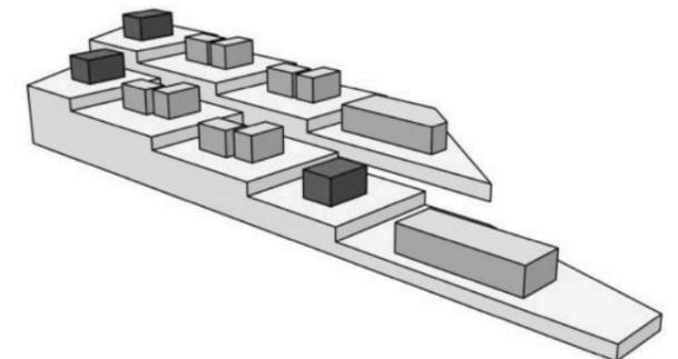
Unter Terrassenbau versteht man in der Architektur die Anordnung von Ebenen auf unterschiedlichen Höhenniveaus innerhalb eines Geländes. Diese Bauweise ermöglicht eine optimale Ausnutzung des unebenen Geländes und eine harmonische Eingliederung der Gebäude in die Landschaft. Sie hat ihren Ursprung in der Weinproduktion, wo sie verwendet wurde, um Hanglagen für den Anbau von Weinreben zu nutzen und Verwitterung zu verhindern.
